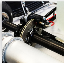
Freno trasero hidráulico, disco ventilado 12mm
