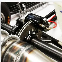
Frein arrière hydraulique, disque ventilé 12mm
