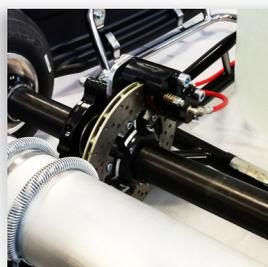
Frein arrière hydraulique, disque ventilé 12mm
