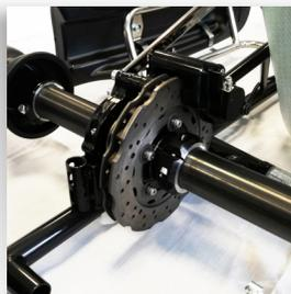
Disque de frein arrière flottant Ø196mm
